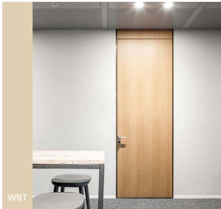
Die wand- und flächenbündigen Zargenmodelle von Küffner stehen für eine klare, schnörkellose Formensprache. Definierte Kantenradien von nur 0,3 – 0,5 mm und eloxierte oder pulverbeschichtete Oberflächen lassen sich nur mit stranggepressten Aluminiumprofilen realisieren. Die hochwertige Verarbeitung, kombiniert mit unsichtbarer Befestigungstechnik, garantiert zeitloses Design und perfekte Funktion für anspruchsvolle Bauvorhaben.
