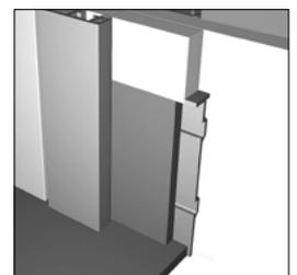
**C** - Sockel für die Aufnahme von Bodenbelägen, wahlweise mit Hohlkehprofil
