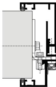
Einbau mit mindestens 8 Stück verzinkte 3-D-Stahlschraubanker zur „schaumfreien“ Befestigung und einfachen Justierung des Falzteils im eingebauten Zustand, bis Türgewicht 120kg. (Befestigungsschrauben bauseits)
