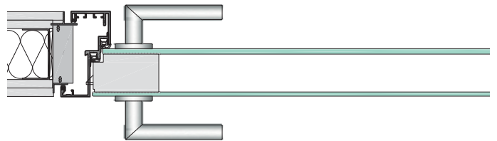
GVT70 mit Doppelfalz - Aluminiumzarge UDSBV-G, mit Schattennut
