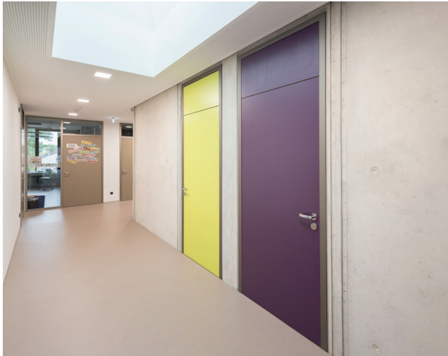
BU 1: Weiterentwicklung der bewährten Küffner Aluminiumzargen: Flächenbündige Blockzarge TLS für 50 mm dicke Türblätter.
