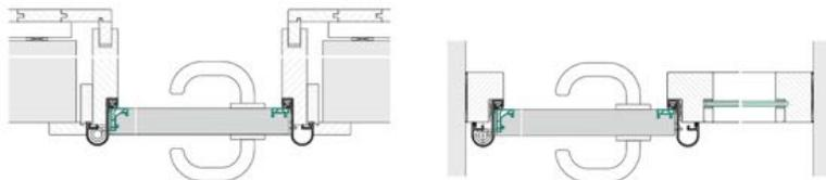
(BU): Küffner-Fingerschutztüren mit HFI-Falzprofilzarge in Kombination mit handwerklich gefertigten Holzzargen
