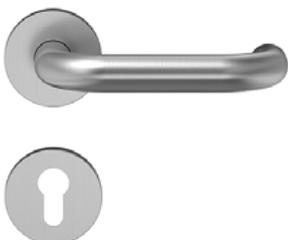
Edelstahl Objektgarnitur U-Form, matt gebürstet, mit OGL Click Gleitlagertechnik, geprüft nach EN 1906 Klasse 4, 8 mm Vierkantstift mit Spezialmadenschrauben. Befestigung beidseitig unsichtbar. Drücker festdrehbar gelagert in Stahlunterkonstruktion mit Stütznocken.
