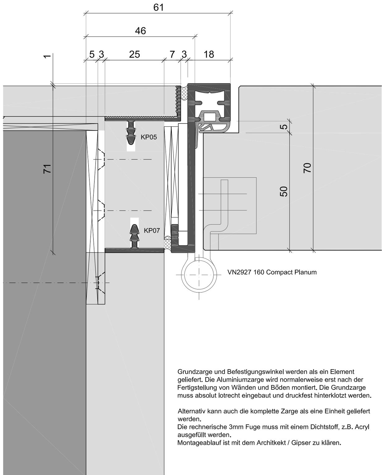
Grundzarge und Befestigungswinkel werden als ein Element geliefert. Die Aluminiumzarge wird normalerweise erst nach der Fertigstellung von Wänden und Böden montiert. Die Grundzarge muss absolut lotrecht eingebaut und druckfest hinterklotzt werden.
